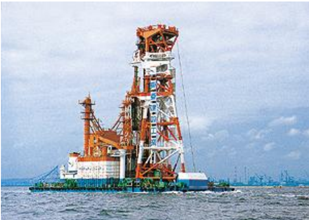
(c) 深層混合處理船
