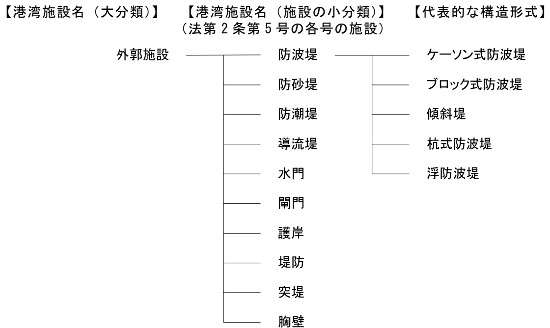
図 3-4.2 外郭施設の種類及び代表的な構造形式
